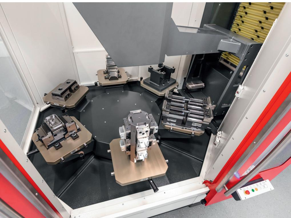
5 Der Marathon P406 verfügt über drehbare Palettenplätze zur Nutzung von komplexen Vorrichtungen oder Spanntürmen – das ist einzigartig in seiner Klasse; die Automation wird seitlich an die Maschine angebaut – dadurch bleibt der Arbeitsraum etwa für eine Einzelteillfertigung in der Tagschicht voll erhalten © Hedelius
